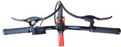
Lenker für den Versand entfernt wurde, positionieren Sie den Lenker in der Mitte des Vorbaus und überprüfen Sie, ob Ihre Griffe an der richtigen Stelle sitzen und der Winkel des Lenkers bequem ist. Ziehen Sie die Schrauben an, um den Lenker in Position zu halten, und stellen Sie sicher, dass alle Bremskabel frei sind. Das empfohlene Drehmoment beträgt 13-14 Nm.
