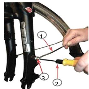
Wenn die Hebeöse des vorderen Kotflügels installiert ist, klappen Sie den Kotflügel so weit wie möglich nach oben, damit der Kotflügel nicht mit dem Reifen kollidiert.
