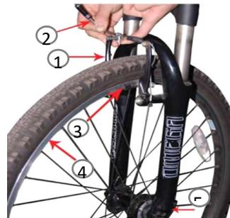
**Anmerkung:** Wenn Sie den Schnellspannhebel des Vorderrads festziehen, drücken Sie die Vorderradgabel mit Kraft nach unten, so dass die Vorderradachse eng mit der Vorderradgabel zusammenarbeiten kann.
